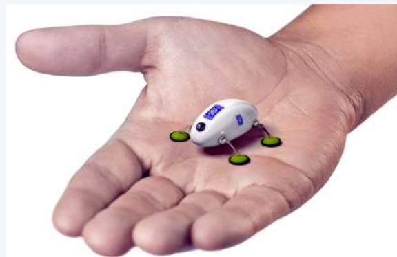
Nano animat conçu par Rolls-Royce pour l'inspection des réacteurs d'avion.
