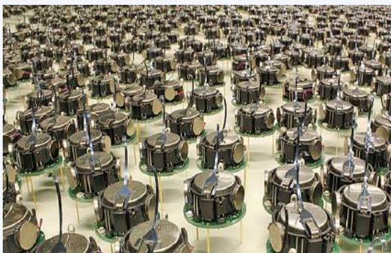
Essaim de 1024 Kilobots (environ 3cm de \phi ) Manip du Pr Michael Rubenstein . Harvard Univ. 2014.
